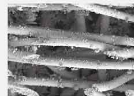
深层过滤 开放式结构使得粉尘和小颗粒能穿透
